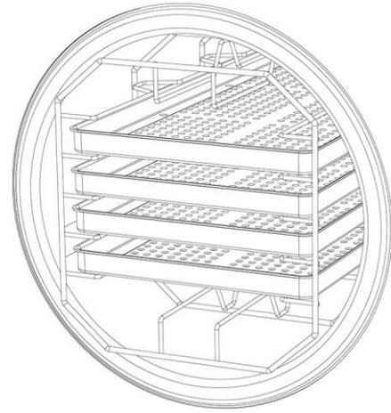
O, extrayendo el soporte portabandejas y girándolo de 90° puede ser usado para alojar "cajas" (3/ 4 compartimientos según el modelo de esterilizadora).
