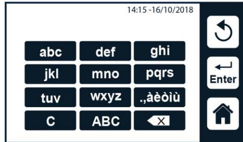
La función Entrada MANUAL permite introducir manualmente el nombre de la red (SSID) y la contraseña (PSW) para la red deseada. Presionar SSID y CONTRASEÑA para habilitar el teclado en la pantalla y luego ENTER para confirmar los datos introducidos.
