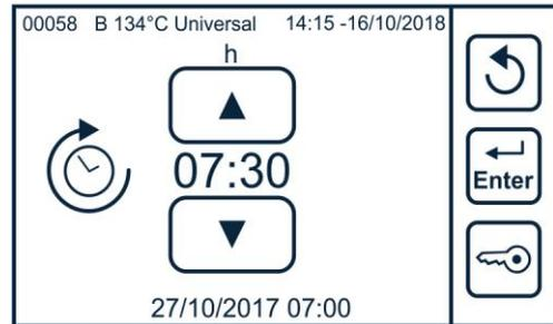
El horario seleccionado se visualizará al lado de la tecla. Presionar la tecla de INICIO; el ciclo comenzará automáticamente a la hora configurada.
